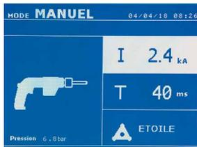
Im EXPERTEN Modus ist die maximale Schweißleistung auf 8.0 kA und 500 ms limitiert. Die Einstellungen im Bedienfeld werden also bei diesen Werten eingeschränkt.
