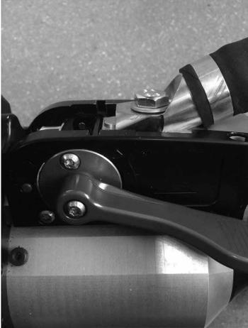
Entfernen Sie den Arm aus der Klemme und befestigen Sie stattdessen das Pistolenkabel.
