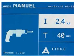
En mode Manuel, l'intensité maximale admise sera de 8 kA pendant une durée qui ne pourra pas excéder 500 ms. Les réglages à l'écran seront donc bloqués à ces valeurs maximum. Régler le générateur en lui indiquant l'épaisseur de la tôle à souder à l'aide des touches + et -. Il est possible de modifier les paramètres courant et temps en mode manuel.
