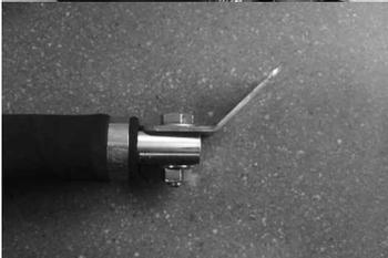
Prüfen Sie, ob die Schraube, die den Schuh mit dem Kabelschuh verbindet, fest angezogen ist.
