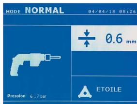
En mode Normal, le pistolet sera limité à des tôles de 1.5 mm maximum. Avec le pistolet, l'opérateur a le choix entre différents outils (mono point, étoile, impact, chauffe rétrainte, goujon, rivet, écrou, molette). La sélection de l'outil se fait avec les touches + et -.
