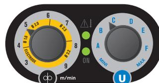
1. Auswahl der Drahtgeschwindigkeit 3 bis 10 m/min (MIG/MAG) bzw. vereinfachte Stromeinstellung bezogen auf den Elektrodendurchmesser (MMA)
