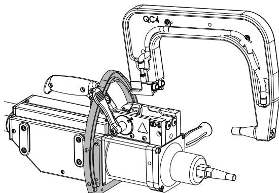
**Het vervangen van de QC sokkel door de QC-G (064102) sokkel is gelieerd aan de procedure van het vervangen van de QC steun door de QC-G op de GYSPOT BP.LQC (064096).**
