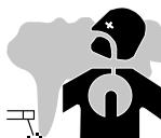
Den svetsrök, gaser och damm som produceras under svetsning är farliga. Det är obligatoriskt att säkerställa tillräcklig ventilation eller utsugning för att leda bort rök och gaser från arbetsområdet. I händelse av otillräcklig lufttillförsel på arbetsplatsen rekommenderas en hjälm med lufttillförsel. Kontrollera att luftintaget är i överensstämmelse med säkerhetsstandarder.
