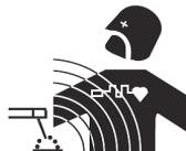
Johtimessa kulkeva sähkövirta saa aikaan sähkö- ja magneettikenttiä (EMF). Hitsausvirta tuottaa EMF-kentän hitsauspiirin ja -laitteiston ympärille.
