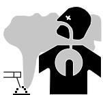
Røyk, gasser og støv som dannes under sveising er farlige. Det er obligatorisk å sikre tilstrekkelig ventilasjon og/eller utledning for å holde røyk og gasser borte fra arbeidsområdet. Hjelm med lufttilførsel anbefales i tilfelle utilstrekkelig lufttilførsel på arbeidsplassen.
