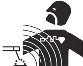
De elektriska strömmar som flyter genom en ledare orsakar elektriska och magnetiska fält (EMF). Svetsströmmen genererar ett EMF fält runt svetsningskretsen och svetsutrustningen.
