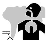
Røg, gasser og støv, som produceres under svejsning er farligt. Det er obligatorisk, at sikre tilstrækkelig ventilation og/eller udsugning, for at holde røg og gasser væk fra arbejdsmiljøet. Det anbefales at bruge en luftforsyning i tilfælde af utilstrækkelig lufttilførsel på arbejdspladsen.
