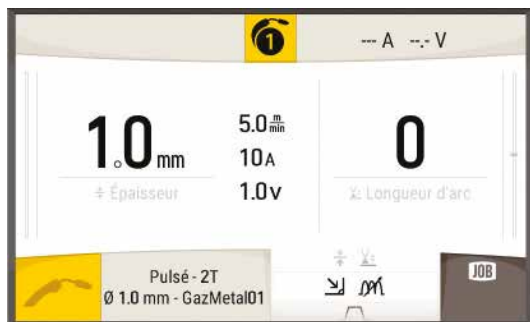
脉冲模式下- 左侧窗口可访问主设置, 右侧窗口则可设置弧长。
