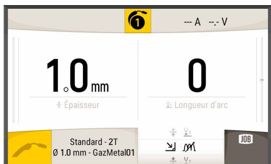
标准模式 - 左侧编码器可设置所选主参数 (厚度, 送丝速度或电流), 右侧编码器可设置弧长。
