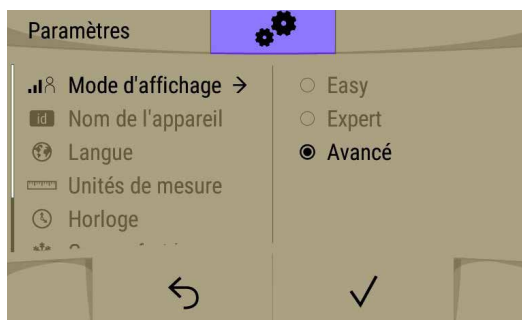
本菜单可显示“显示模式”中的选择(简易界面: 只有选框模式, 无法访问焊接周期; 专业界面: 界面显示简单, 多一个图表模式, 可调整焊接周期不同阶段的时长。高级界面: 界面显示专业, 多一个附加图表模式, 可设置每个阶段的弧长。
