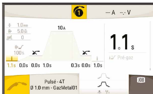
4T模式下, 扳机可操控热启动, 提前送气, 收弧和延气。
