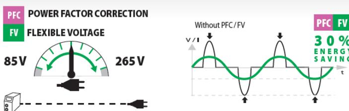
GYSMI E200 FV ima snažan integrisani „korektor snage“ koji omogućava flexibilnu voltažu
