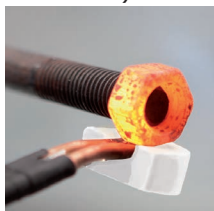
Løsne rustne bolter
