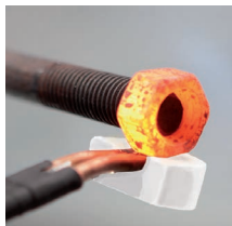
錆びたボルトを取り外す作業
