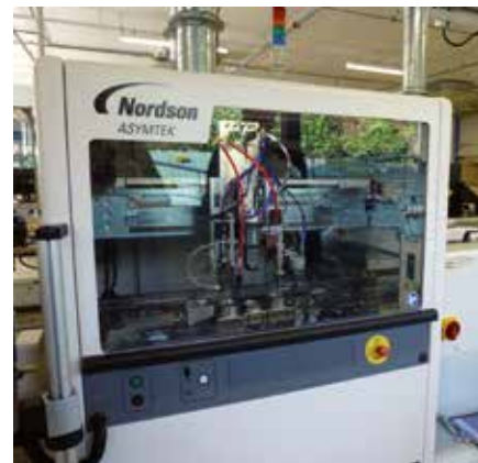
Hala produkcyjna kart elektronicznych wyposażona jest w nowe urządzenie do powlekania, co pozwala na ograniczenie osadzania się pyłu czy korozji. Wszystkie karty firmy GYS będą teraz lakierowane, jest to ważne kryterium dla obszarów, gdzie występuje wysoka wilgotność.
