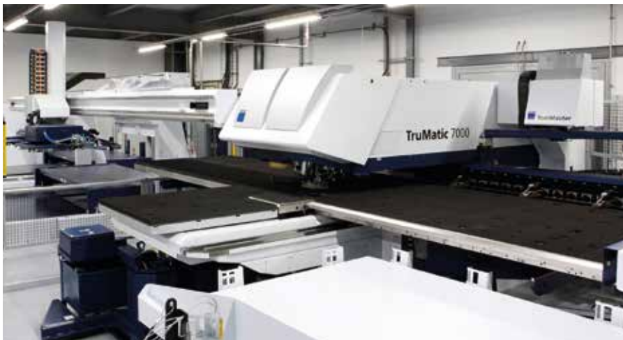
Jedną z najnowszych inwestycji, w tym warsztacie blacharskim, jest to nowe urządzenie z podwójną głowicą, które jest w stanie wykonywać zarówno operacje wykrawania, jak i cięcia laserowego. Pozwala ono na pracę na większych i grubszych częściach, co oszczędza czas i poprawia jakość cięcia.
