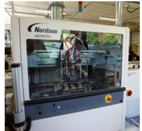
Цех производства электронных плат оснащен новым оборудованием для лакировки, что позволяет ограничить оседание пыли и коррозию. Все платы GYS теперь будут покрываться лаком, что является важным критерием для использования в помещениях с высоким процентом относительной влажности.
