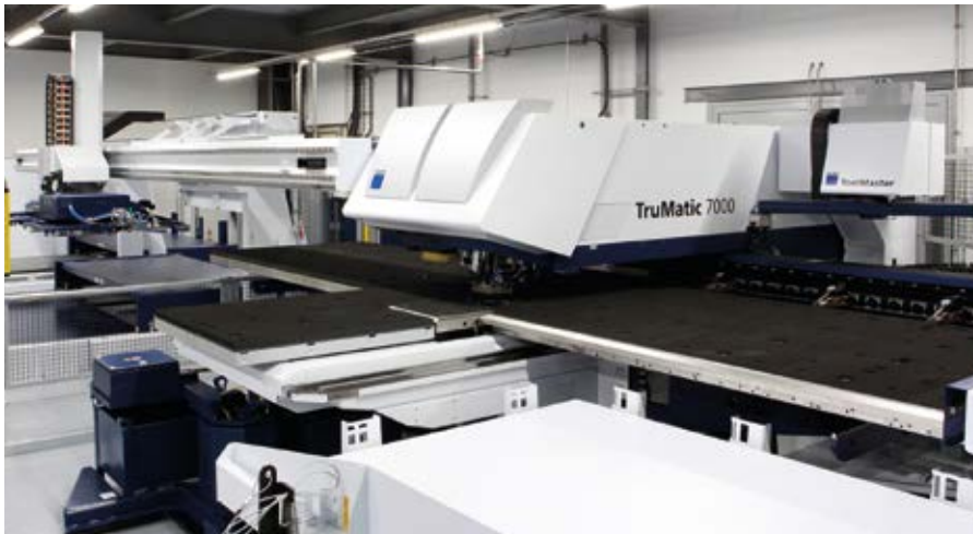
Часть инвестиций была распределена на покупку для жестяного цеха станка с двойной головкой, который может выполнять как операции по штамповке, так и по лазерной резке. Это позволяет обрабатывать листы большей толщины, экономя при этом время и получая срез лучшего качества.
